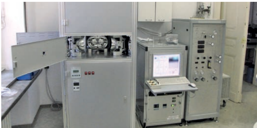
Nové magnetické materiály se připravují v optické peci. Foto archiv UNCE 204023
