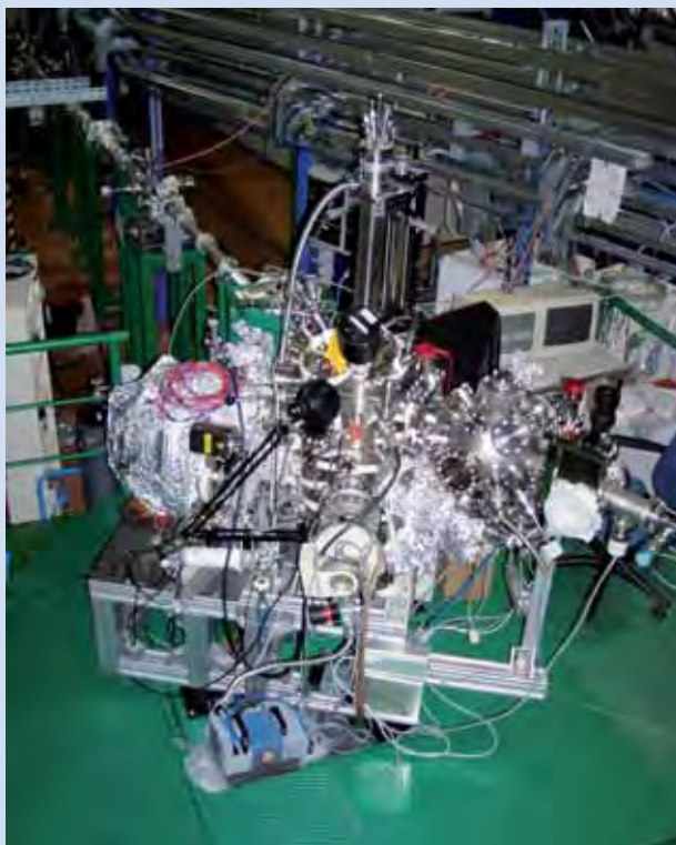
Fotoelektronový spektrometr MSB s trubicí optické dráhy v experimentální hale synchrotronu Elettra.
