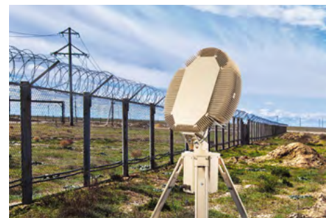
Radar ReGUARD společnosti RETIA je víceúčelový 3D radar pro detekci a současné sledování pozemních cílů a pomalých nízkoletících cílů s malou odraznou plochou.
